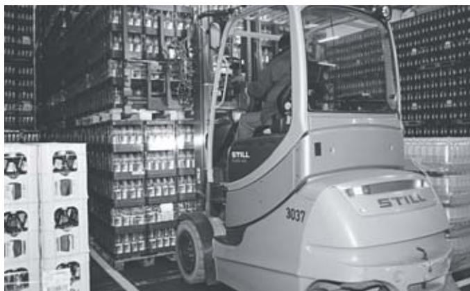
Bonne visibilité au-dessus des charges hautes (surélévation du poste de conduite)
