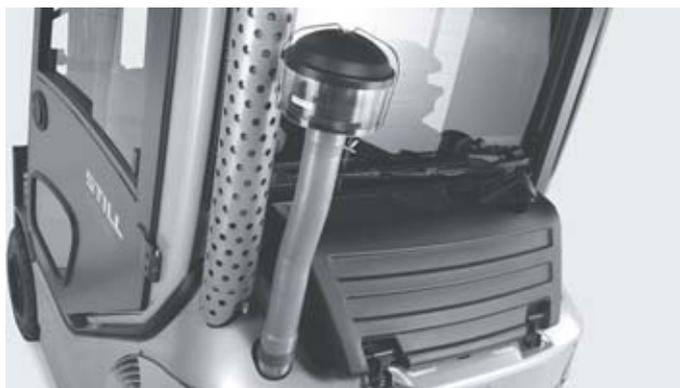
Filtre Cyclonique purifiant l'admission d'air du moteur
