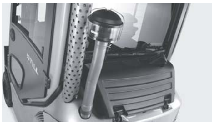
Filtre Cyclonique purifiant l'admission d'air du moteur
