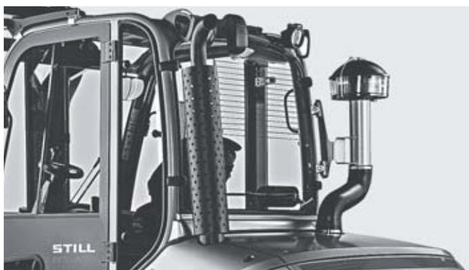
Filtre cyclonique purifiant l'admission d'air du moteur
