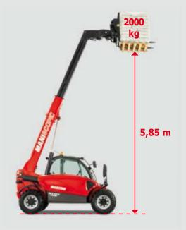
Placer une palette jusqu'à 2 T au 1er étage d'un bâtiment.
