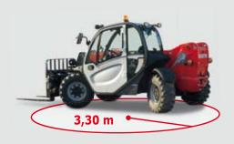
4 ROUES DIRECTRICES pour manœuvrer aisément 3 modes de direction
