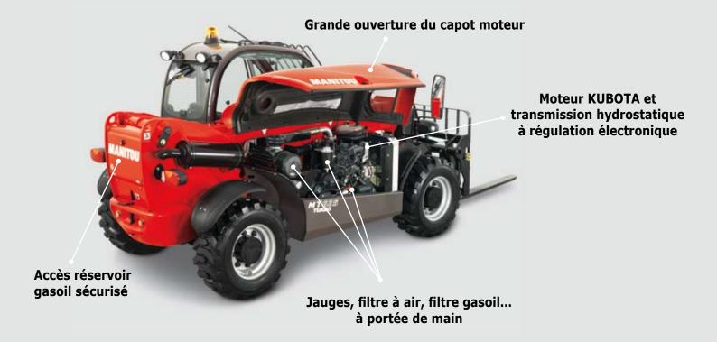
L'extrême accessibilité des organes mécaniques, l'affichage des intervalles d'entretien et des codes diagnostics sur le tableau de bord facilitent les interventions de maintenance.
