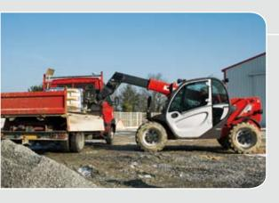
Décharger un camion d'un seul côté ou placer une palette de 1,2 T à 2,50 m devant les roues et jusqu'à 800 kg à 3,40 m.
