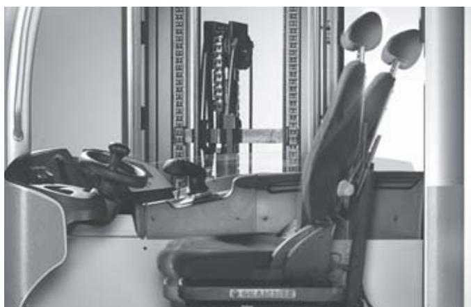
Le siège inclinable permet une visibilité constante sur la charge
