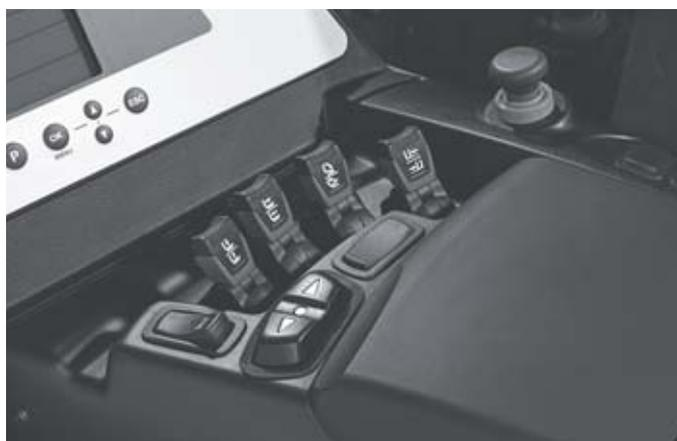
Pilotage simple de toutes les fonctions sans changement de position de la main - par à l'aide quatre mini-levers (Fingertip)
