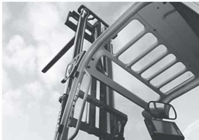
Fenêtre de contrôle sur le toit du poste de conduite pour une visibilité parfaite de la charge en surplomb
