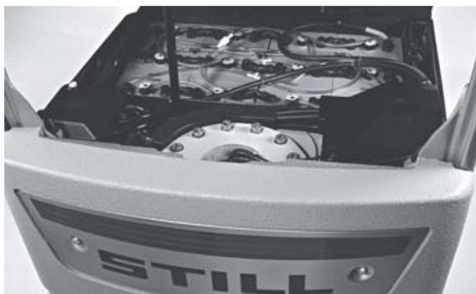
Accès direct à la batterie grâce un compartiment de batterie avec large ouverture
