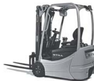
Le RX 50 est le chariot élévateur à contrepoids, trois roues, électrique le plus compact de sa catégorie. Ce membre de la famille de chariots élévateurs électriques STILL est plus fort que jamais : ce chariot élévateur électrique intelligent, après avoir fait l'objet d'une reconception complète, vient maintenant révolutionner les normes de transport de charges, entre 1,0 et 1,6 tonnes.
