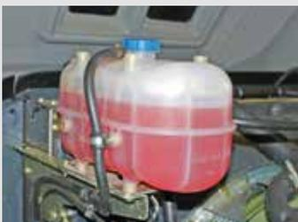
Les réservoirs translucides et les hublots permettent de vérifier le niveau des fluides d'un seul regard.
