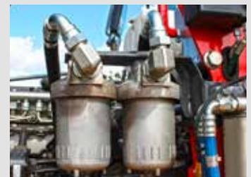
Nous offrons en option des filtres de boîte de vitesses déportés, permettant un remplacement facile et propre.
