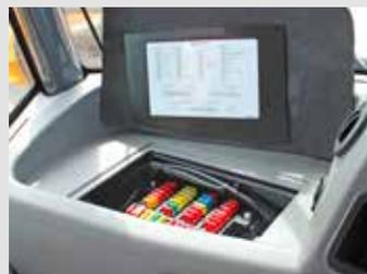
Un boîtier centralisé dans la cabine facilite le remplacement des fusibles. En outre, le faible nombre de relais, connecteurs et faisceaux renforce nettement la fiabilité.
