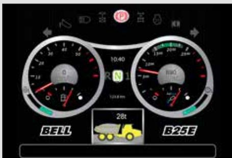
Le pesage embarqué exclusif, permet une information en temps réel de l'état de charge du véhicule pendant la durée du chargement. Une fonction « limitation de vitesse » peut également être activée en cas de surcharge significative.
