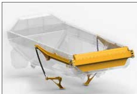
La porte arrière, disponible en option, réduit la perte de matériaux pendant le transport. La porte s'ouvre lors du basculement de la benne. Les sangles ressort en acier fournissent une étanchéité parfaite pendant le transport et minimisent la perte de matériaux.
