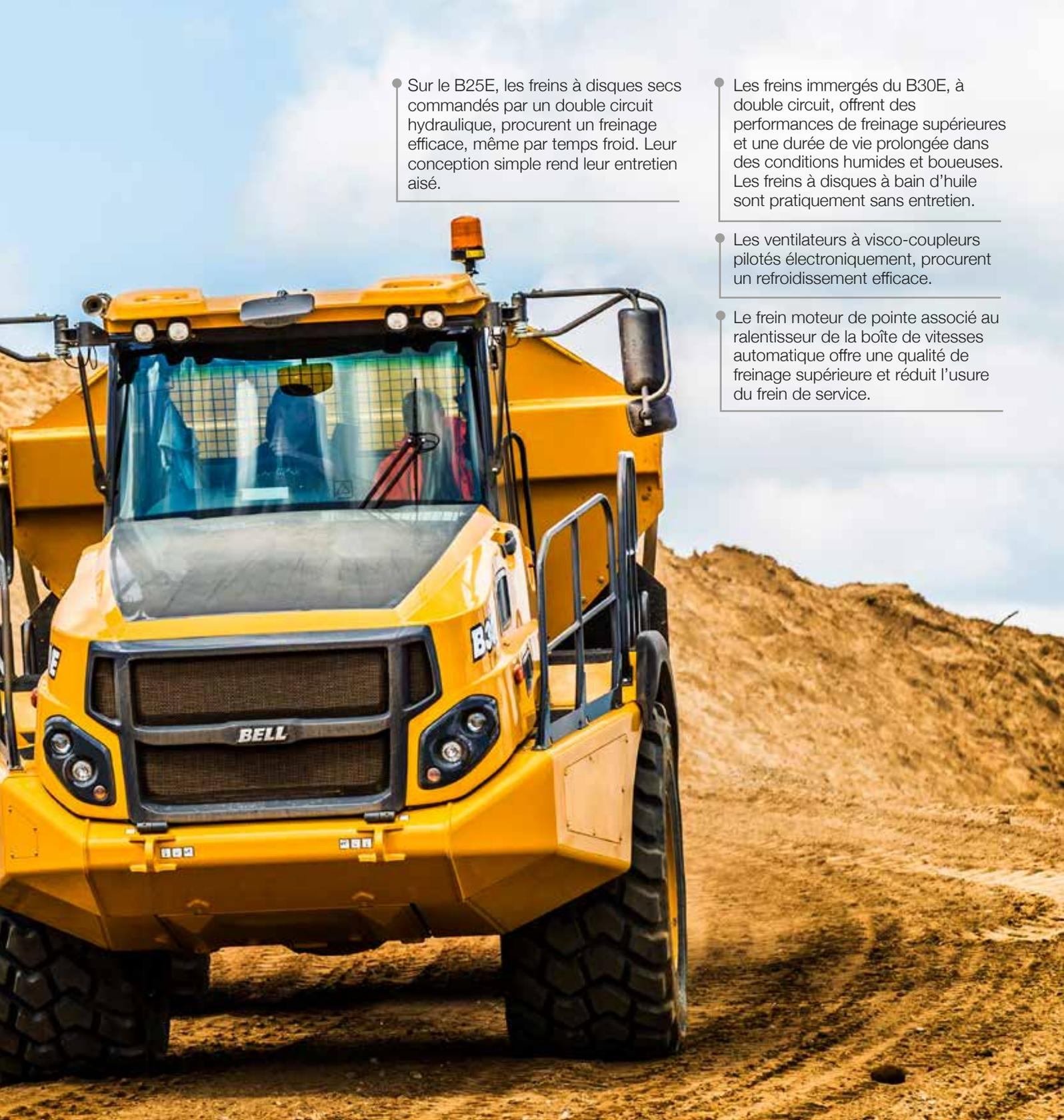
● Sur le B25E, les freins à disques secs commandés par un double circuit hydraulique, procurent un freinage efficace, même par temps froid. Leur conception simple rend leur entretien aisé.
