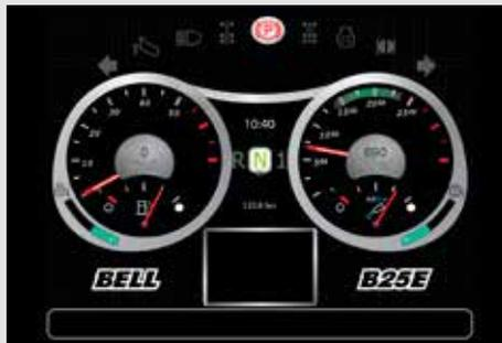
Un moniteur couleur de 10 pouces affiche les informations d'utilisation vitales, les avertissements de sécurité, les données de diagnostic détaillées et les paramètres de fonction de la benne basculante.
