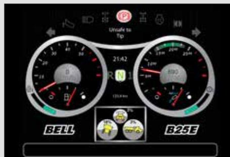
Le montage d'un capteur d'inclinaison et de devers, permet d'interdire le bennage si la machine n'est pas en position de sécurité.
