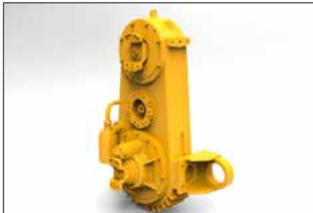
Le différentiel inter-pont de la boîte de transfert assure une répartition équilibrée du couple sur chaque pont lorsque la traction est favorable. Si les conditions se dégradent, le blocage du différentiel se déclenche automatiquement pour transmettre le couple aux pneus qui offrent la meilleure adhérence.
